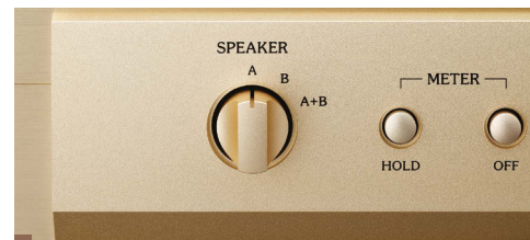
Funkcja Hold zamroza szczytowy poziomysterowania ułatwiając sprawdzenie, w jakim zakresie mocy pracuje wzmacniacz.
