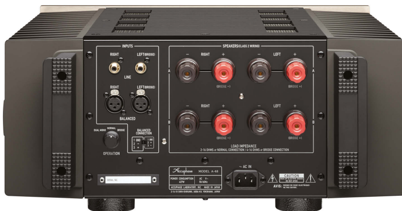
Dwie pary, typowych dla „Accu”, bardzo wygodnych i bezpiecznych terminali głośnikowych, przełącznik trybów pracy i dwa typy wejść – więcej oczekiwać nie sposób.
