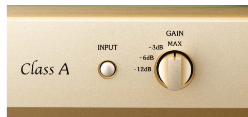
Wygodny wybór wejść z czołówki i regulacja gainu układu wzmocnienia wstępnego. W połączeniu RCA w systemie red. naczelnego występował niewielki brum, który skutecznie ograniczyło ustawienie -12 dB.
