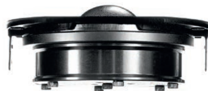
Głośnik wysokotonowy nazwany został Esotar 2 , ale oryginalnego Esotara D330, referencję z lat 90-tych ubiegłego wieku, przypomina tylko 28-mm, jedwabną kopułką, chociaż i ona jest obecnie inaczej nasączana. Neodymowy magnes to górny, płaski pierścień, głębszy pierścień na pierwszym planie tworzy komorę wytłumiającą, zamkniętą płaską płytką.
