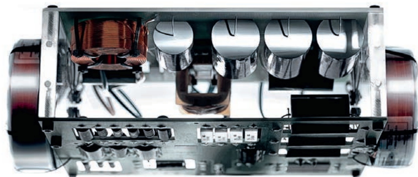
Głośniki średnionowe i wysokotonowe zostały przykręcone od wewnątrz, do panelu frontowego swojej sekcji, wykonanego z 4-cm bloku aluminium. Głośniki wysokotonowe zbliżono do siebie tak, jak tylko pozwalały na to ich układy magnetyczne, a w głośnikach średnionowych, w tym też celu, przycięto kosze. Bliskość głośników wysokotonowych i średnionowych jest zalecana w każdym układzie, symetrycznym i niesymetrycznym.
