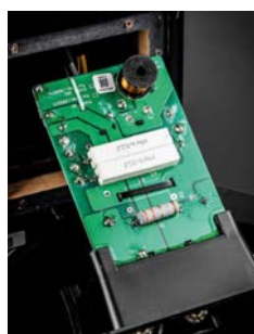
Zwrotnica z filtrami drugiego rzędu dzieli pasmo w dwóch punktach – w sposób niesłyszalny. Jej topologia jest dość prosta, a elementy dobrej jakości – lepszej niż u rywali.
