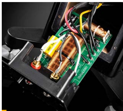
Zwrotnica z filtrami drugiego rzędu dzieli pasmo w dwóch punktach – w sposób niesłyszalny. Jej topologia jest dość prosta, a elementy dobrej jakości – lepszej niż u rywali.
